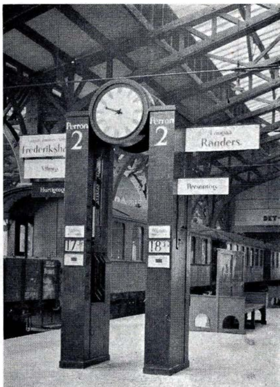
Fig. 184. Øverste Skilt angiver de første Knudestationer, mellemste Forbindelser og nederste Togets Art, idet Skiltet for Lyntog er gult, for Hurtigtog rødt og for Persontog hvidt. Paa Togviserne findes iøvrigt Ur samt Angivelse af Afgangstid og Forsinkelse.
