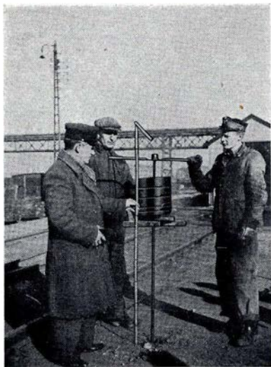
Fig. 27. Boring med »belastet Spidsbør«. Belastningen er 100 kg, og Nedsynkningerne maales for hver 25 halve Omdrejninger.
