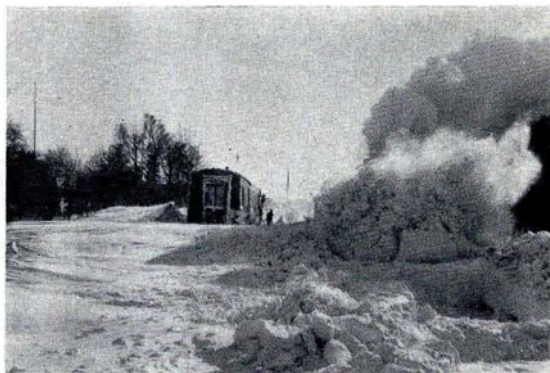
Fig. 254. Sneplov i Arbejde. Af Dampen fra Lokomotivet fremgaar, at dette arbejder for fuld Kraft for at føre Ploven, der næsten er begravet i Sne, gennem Driven. Der er udgravet Huller i Sneen for at lette Pløjningen.
